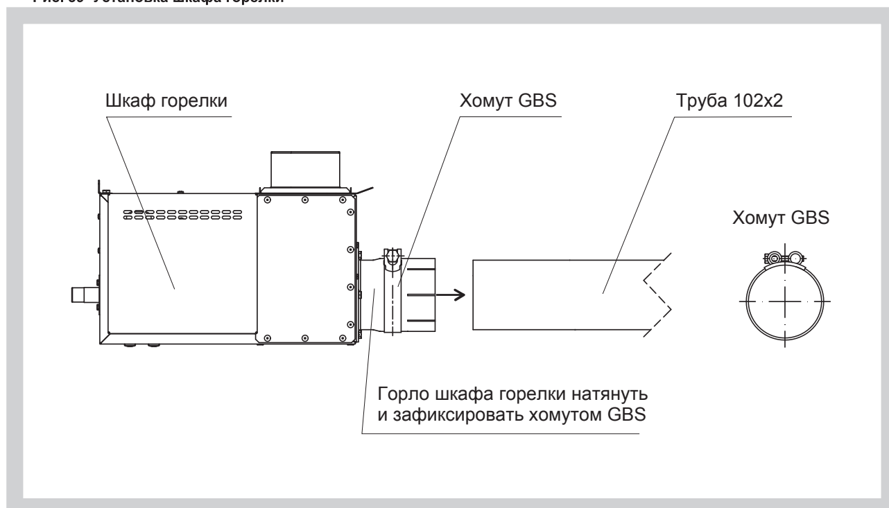
Рис. 39 Установка шкафа горелки
