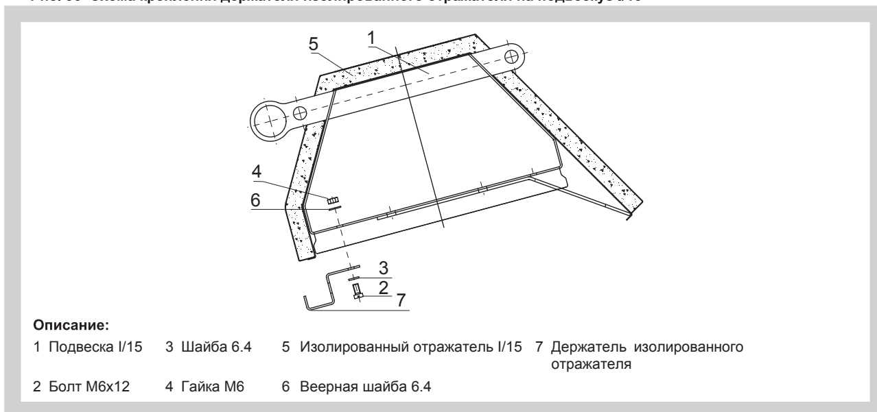
Рис. 36 Схема крепления держателя изолированного отражателя на подвеску I/15
