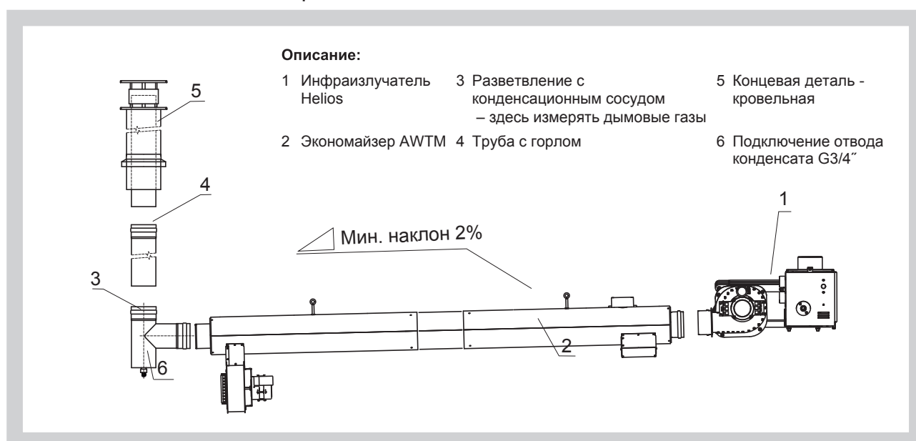
Рис. 52 Схема монтажа экономайзера AWTM
