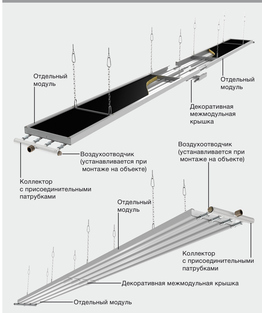
Рис. 3. Потолочная панель Zehnder 1ZIP в сборе
