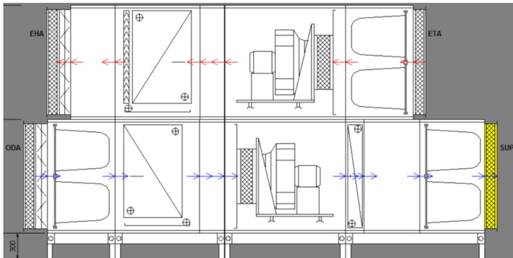
Внутренняя установка с гликолевым рекуператором, 2-х ступенчатой фильтрацией и водяным обогревом.
