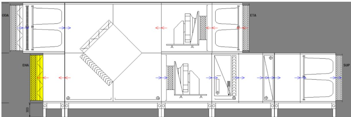
Внутренняя установка с пластинчатым рекуператором, прямым охладителем, водяным обогревателем и 3-х ступенчатой фильтрацией.
